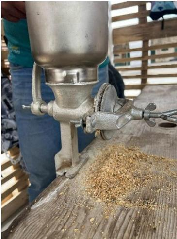
**Figura 3.3** Molino mecánico para triturar esquilmo.
