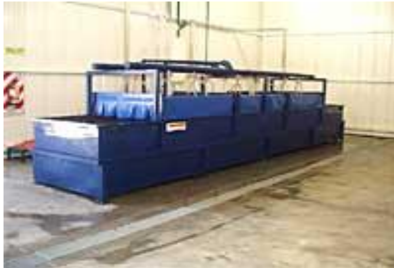
Figura 14. Maquina de hidrogenfriado
