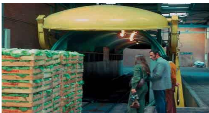
Figura 17. Cámara de enfriamiento por vacío (Fuente: FAO, 2012)
