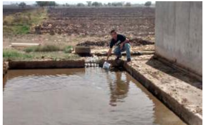
Figura 4. Toma de muestra del agua residual en el canal desarenador.
