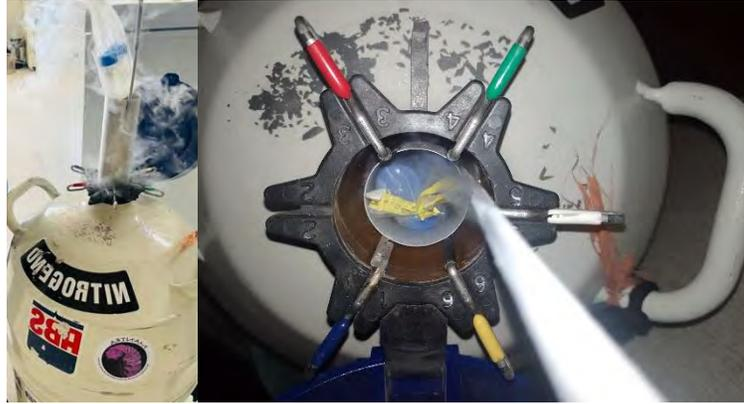
Figura 11. Tanque conservador de nitrógeno líquido.
