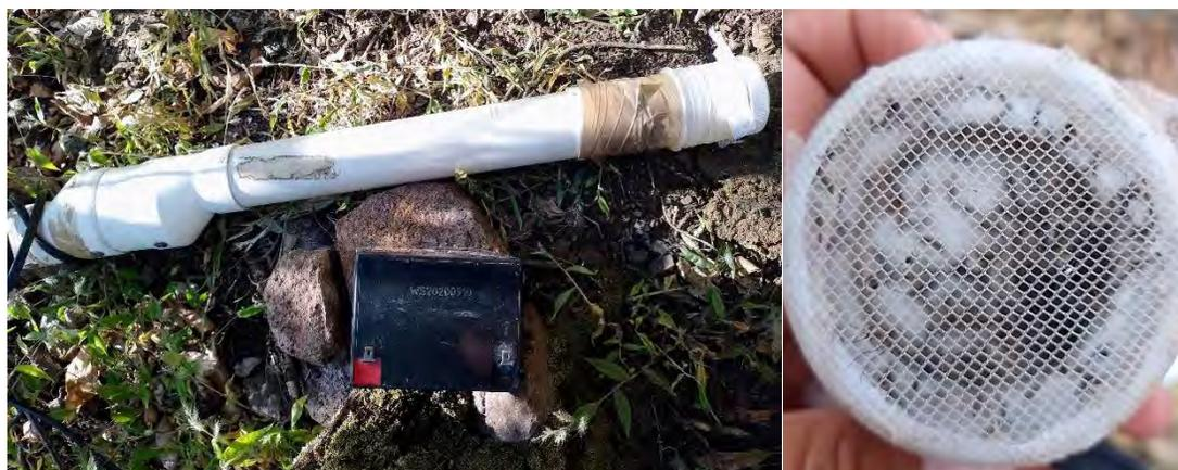
**Figura 8. Aspirador mecánico y vial de recolección**
