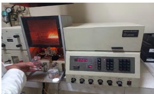
Figura 26.- Determinación de oro y plata en el espectrofotómetro.
