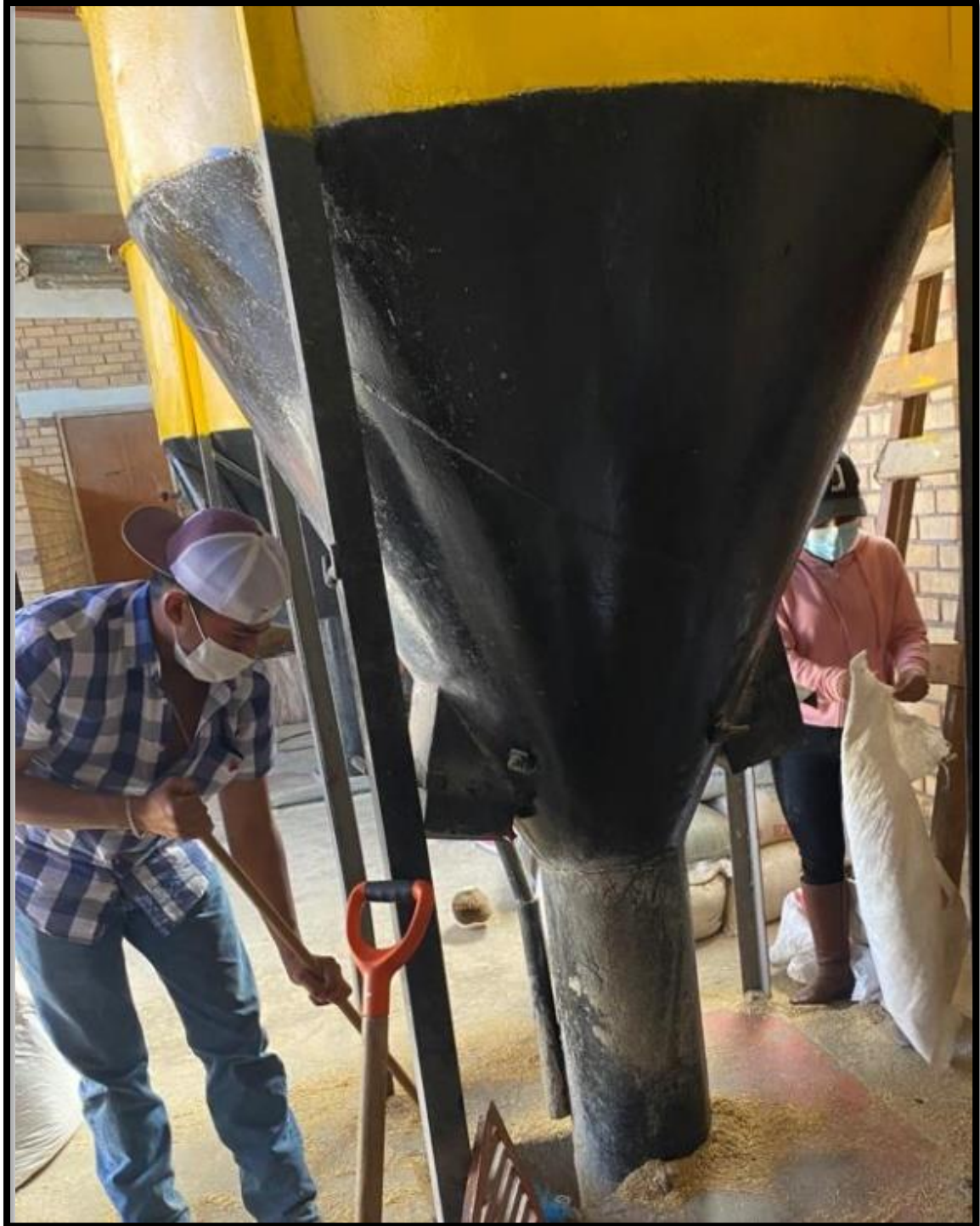
Figura 3.2.3. Mezcladora de alimento vertical marca azteca 5hp con capacidad de 1T.
