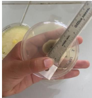
Figura 18. Medición del crecimiento radial del hongo a los 7, 14 y 21 días de incubación.
