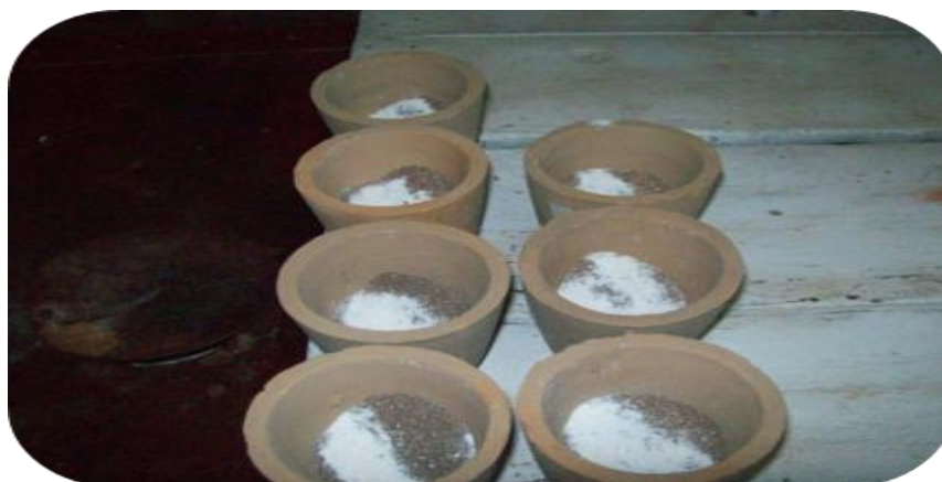
Crisoles con mezcla de fundente y concentrado
