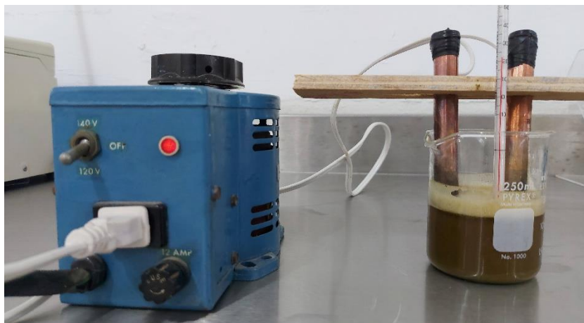
Figura 6.- Extracción de polifenoles por calentamiento óhmico.
