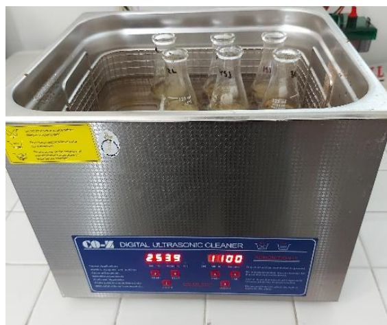
Figura 5.- Extracción de polifenoles en un baño CO-Z DIGITAL ULTRASONIC CLEANER.
