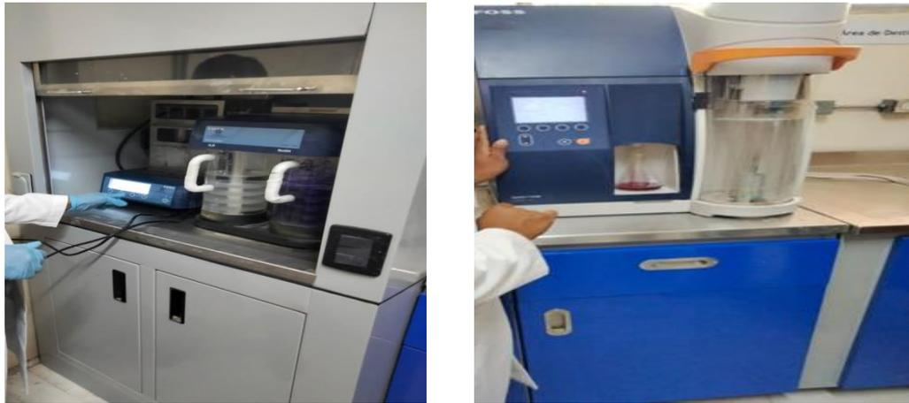
Figura 9,10. Obtención de proteína cruda por el método de KJELTEC
