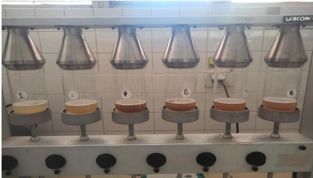
Figura 8. Obtención de fibra detergente neutra y fibra detergente acida
