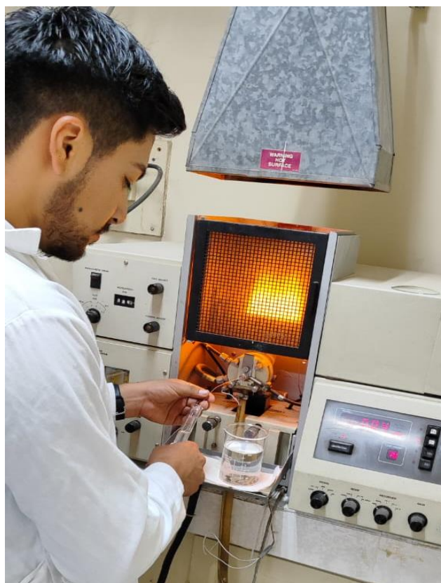
Figura 8. Análisis de contenido de micronutrientes con ayuda del Espectrómetro de emisión atómica de plasma.
