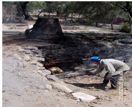
Figura No.12 Calentamiento del alambique.
