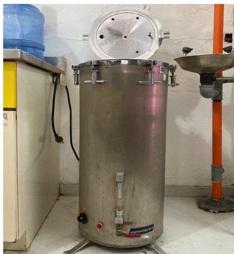
**Figura 9.** Autoclave para esterilizar los medios de cultivo.
