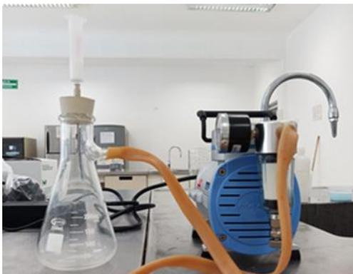
**Figura 5.** Bomba de vacío.
