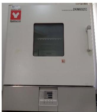
**Figura 1.** Estufa para secado por convección.
