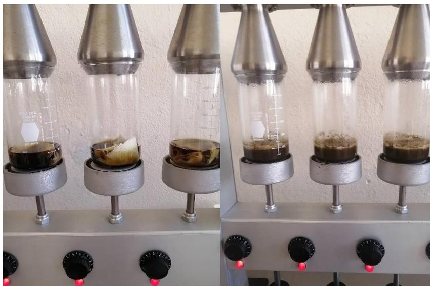
**Figura 10.** Proceso de análisis de Fibra Cruda
