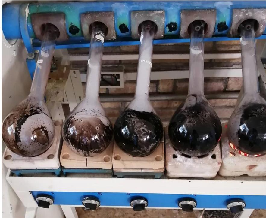
**Figura 8.** Proceso de análisis de Proteína Cruda
