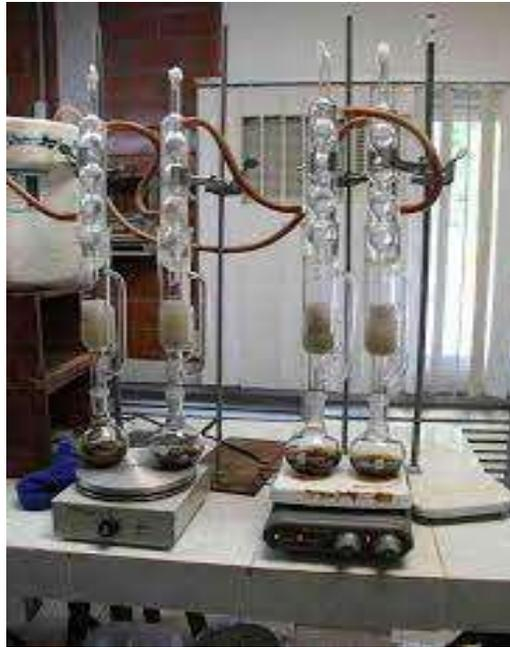
**Figura 15. Equipo de extracción y determinación de grasa**
