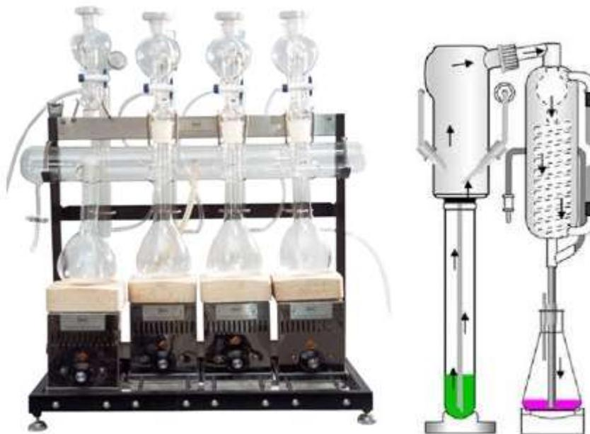
**Figura 16. Equipo de Kjeldahl para determinar proteína**
