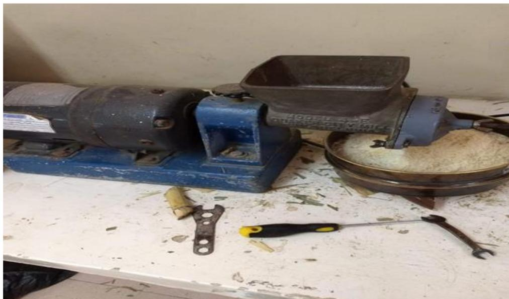
Figura 12. Trituración y tamizado de la materia seca para la obtención de las calidas de maíz forrajero.
