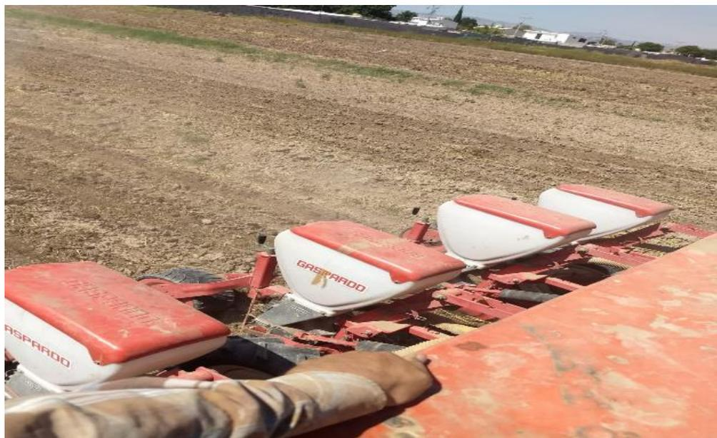
Figura 5. Sembradora de la marca GASPARDO de precisión de cuatro hileras.
