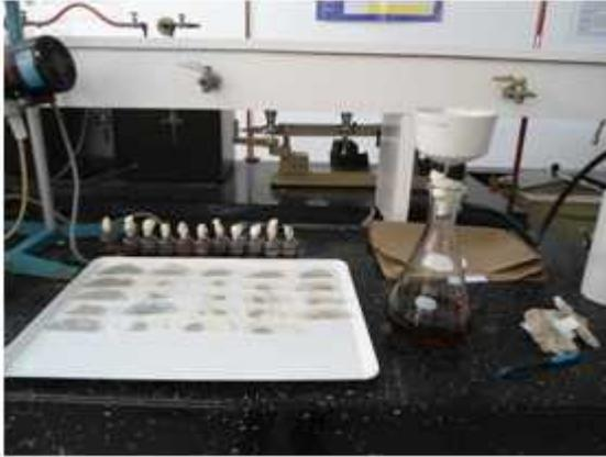
Figura 14.- Filtración con bomba de vacío
