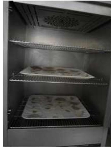
Figura 15.- Muestra en el horno de secado
