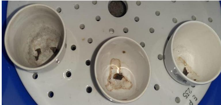
**Figura 9.** Determinación de cenizas.
