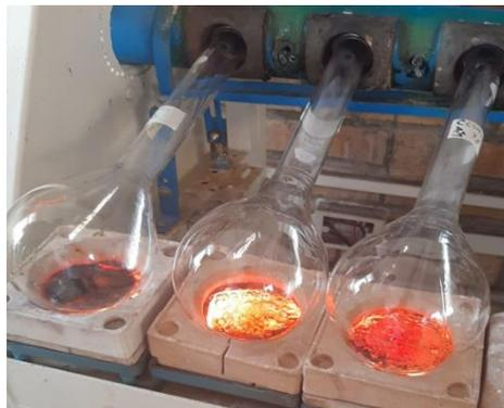
**Figura 10.** Proceso de digestión para determinar proteína cruda
