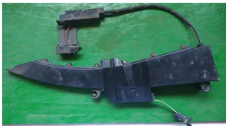
Figura 2. Sensor opto electrónicos de caída de semillas reales (H21A1)
