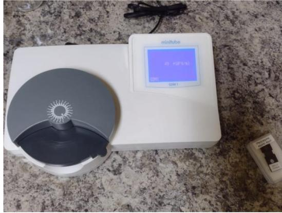
**Figura 12 Fotómetro SDM 1 para análisis de la concentración de semen**
