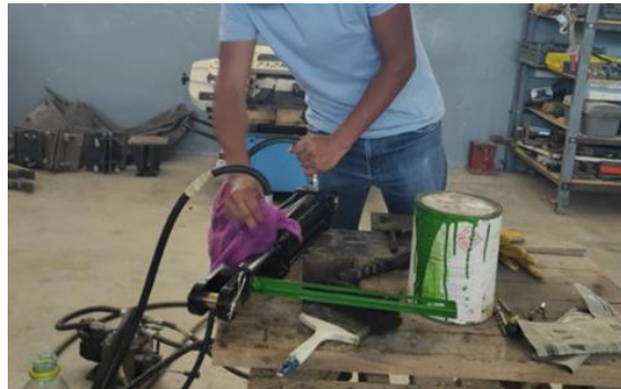
Figura 3.8 Limpieza de electroválvula Danfoss.
