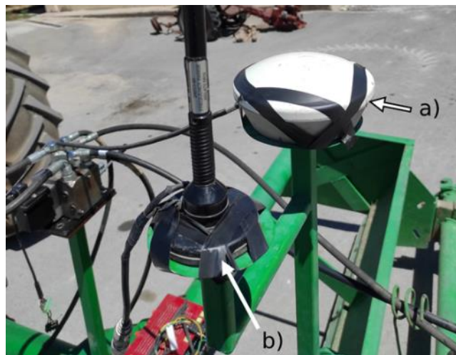
Figura 3.4 a) Antena de corrección RTK, b) Receptor GPS móvil.
