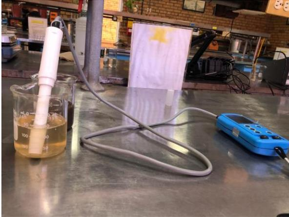
*Figura 4. Medición de pH y CE Marca HANNA.*
