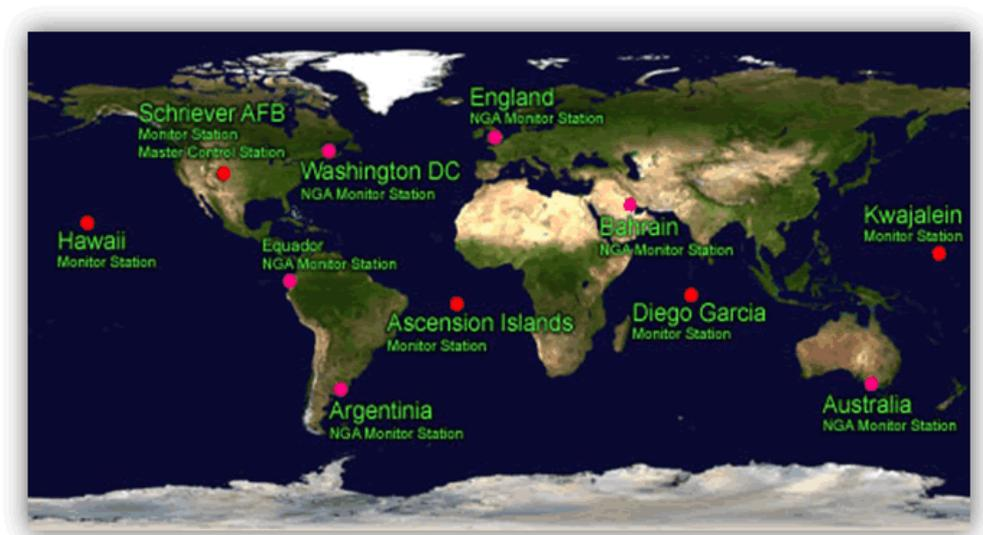
Figura 2. Posición de las estaciones de seguimiento y la estación principal de control (<http://www.inegi.org.mx/geo/contenidos/geodesia/gps.aspx>).
