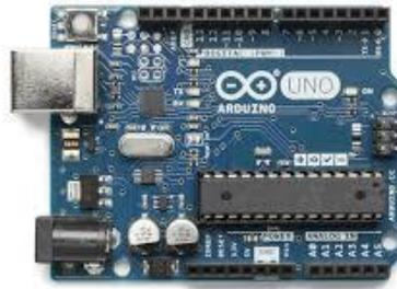
**Figura 3.2** Placa Arduino UNO microcontrolador para el sensor.
