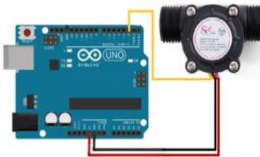
**Figura 4.1** Conexión del microcontrolador hacia el sensor YF-S201.
