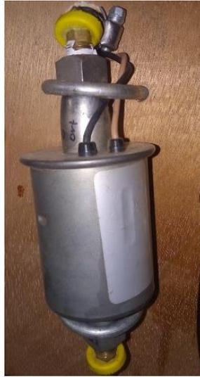
**Figura 3.4** Bomba de inyección de uso automotriz.
