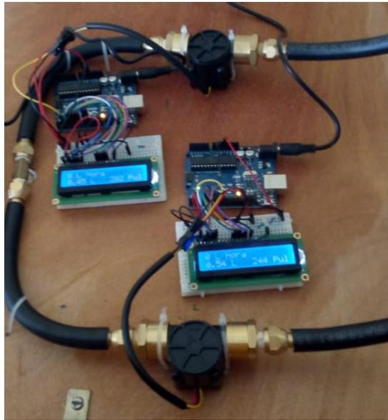
**Figura 4.4** Señal de las conexiones de los sensores.
