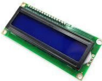
**Figura 3.5** Pantalla digital LCD para visualización de los resultados del sensor.
