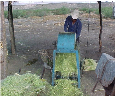
Figura 6. Extracción de la fibra de la lechuguilla ( Agave lechuguilla Torr.) con el método de tallado a máquina. En la imagen de la derecha nótese los grandes volúmenes de guishe después del proceso de desfibrado.
