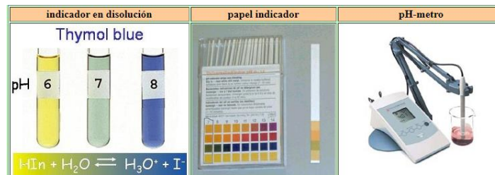
Figura 8: Métodos para medir pH
