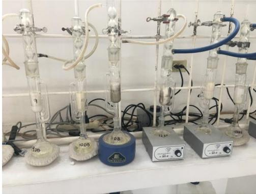
Figura 4. Extracción de grasa por método Soxhlet.
