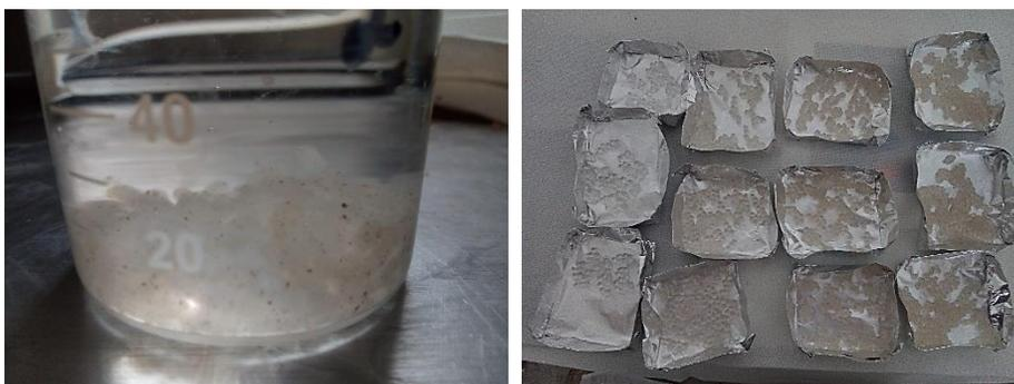
**Figura 9.** Cápsulas en solución de  $\text{CaCl}_2$  y en deshidratación.
