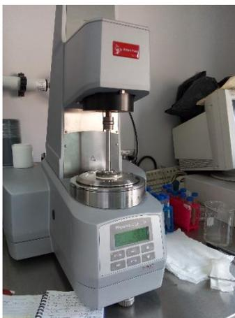
**Figura 8.** Viscosímetro de cono y plato Physica MCR 501.
