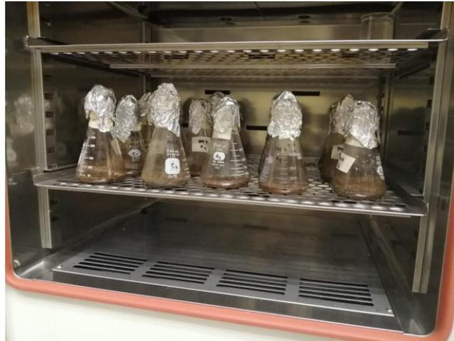
**Figura 11.** Sistema para la fermentación en medio sólido (FMS) de la cinética de producción de proteasa producida por *Yarrowia lipolytica*.
