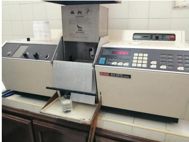
**Figura 9.** Espectrofotómetro de absorción atómica donde se lleva a cabo la lectura de micro y macro nutrientes.
