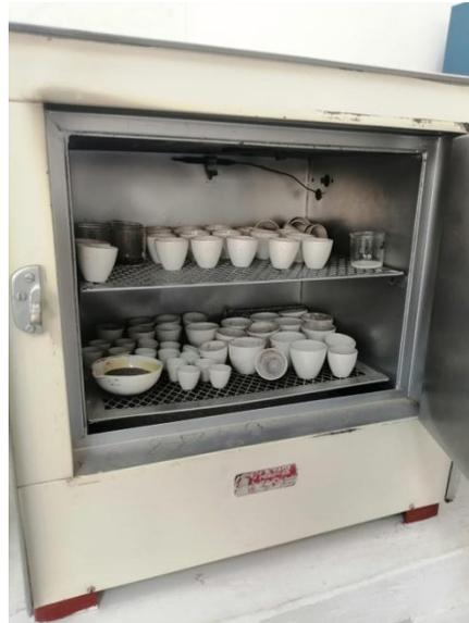
**Figura 4.** Equipo para la determinación de materia seca total (MST).
