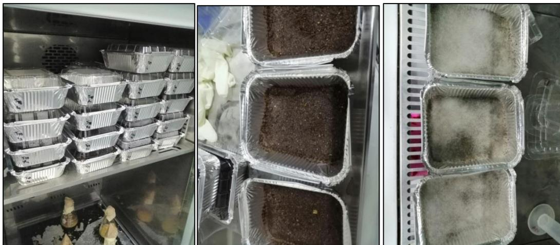
**Figura 12.** Sistema de fermentación en medio sólido (FMS) utilizando charolas.
