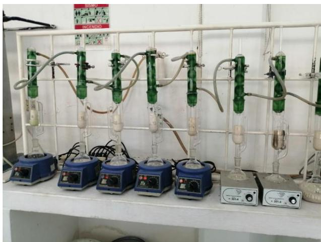
**Figura 6.** Equipo utilizado para la determinación de extracto etéreo por el método Soxhlet...
