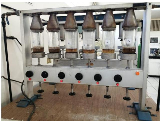
**Figura 8.** Equipo Labconco para la determinación de fibra cruda
