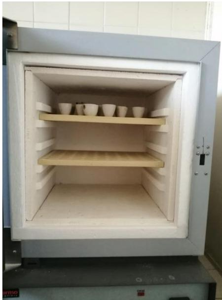
*Figura 5. Mufla, equipo utilizado para la determinación de cenizas.*
