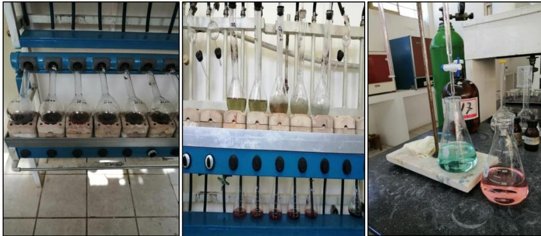
**Figura 7.** Equipo Kjeldhal utilizado para la determinación de nitrógeno (por conversión proteína cruda o bruta), se aprecian los 3 procesos que conlleva el método (digestión, destilación y titulación).
