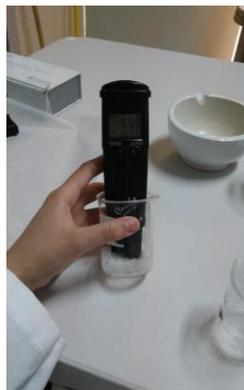
*Figura 11 Determinación del pH en el queso tipo manchego*
