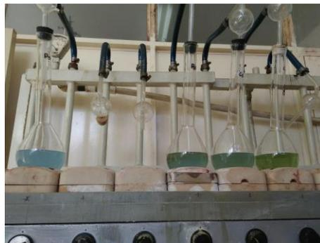
*Figura 15 Determinación de Proteína en el queso tipo manchego*
