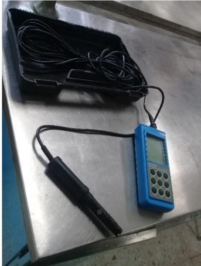
Figura 18. Medidor de Oxígeno Disuelto
