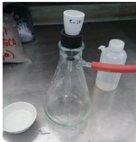
Figura 12. Aplicación de vacío a la muestra
