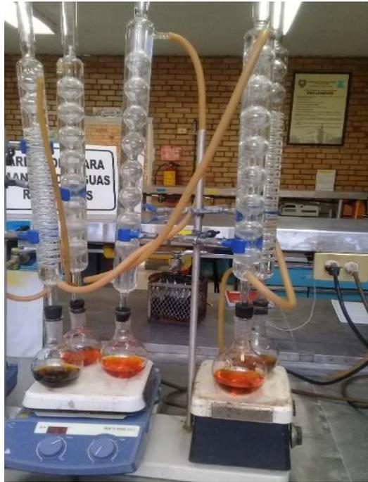
Figura 17. Ebullición de las muestras en el aparato de reflujo.
