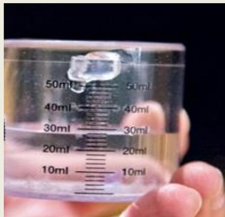
**Paso 5** Registre el número de mililitros (ml) que indique el cilindro medidor multiplique por 2 este valor para obtener el flujo de agua que pasa por segundo a través del niple
