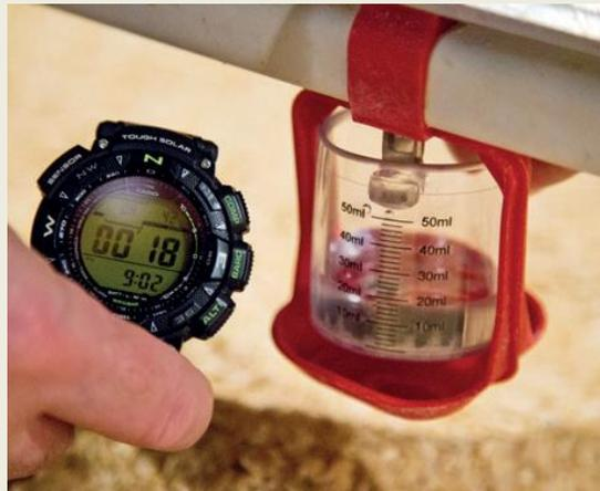
**Paso 4** cuando el temporizador o el cronometro marque 1 segundo desactive el niple para detener el flujo del agua
