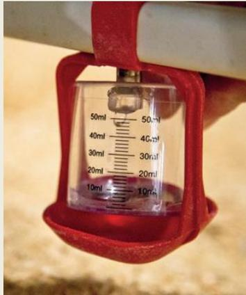
**Paso 3** inicie el temporizador o cronometro durante 1 segundo y active el niple al mismo tiempo para que el agua empiece a fluir libremente hacia el cilindro medidor
