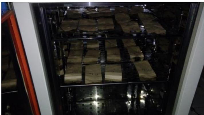
Figura 21. Secado de muestras en horno de secado Marca TERLAB Modelo TE-H70DM.
