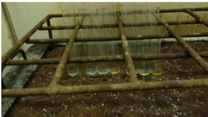
Figura 27. Retiro de las muestras que permanecieron en la plancha por un período de entre 2 y 3 h, el digestado se tornó transparente y tuvo un volumen de aproximadamente 1 ml.
