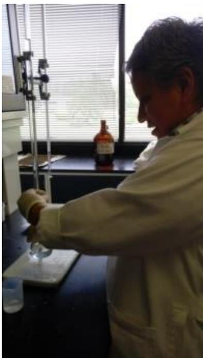
Figura 33. Titulación con la solución de ácido sulfúrico 0.05 N previamente colocado en la microbureta de 10 ml hasta que se presentó el vire de color azul a rosa.
