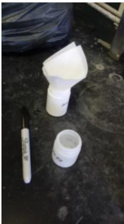
Figura 29. Filtrado del digestado en frascos de vidrio usando papel filtro de poro medio.
