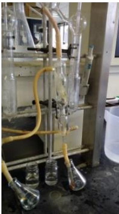
Figura 32. El destilado se recibió en 20 ml ácido bórico al 4% más 0.2 ml de indicador (verde bromocresol y rojo de metilo), en matraces Erlenmeyer hasta alcanzar un volumen aproximado de 50 ml.
