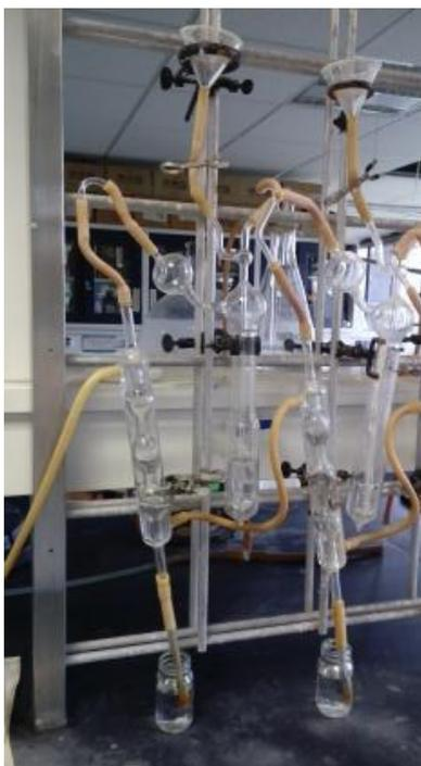
Figura 31. Se colocó en el equipo de destilación los 10 ml del filtrado, se adicionaron 10 ml de NaOH (50%), e inició el calentamiento.
