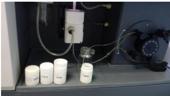
Figura 34. Succión de muestra a la cámara de atomización del ICP-Optical Emission Spectrometer Marca VARIAN Modelo 725-ES.
