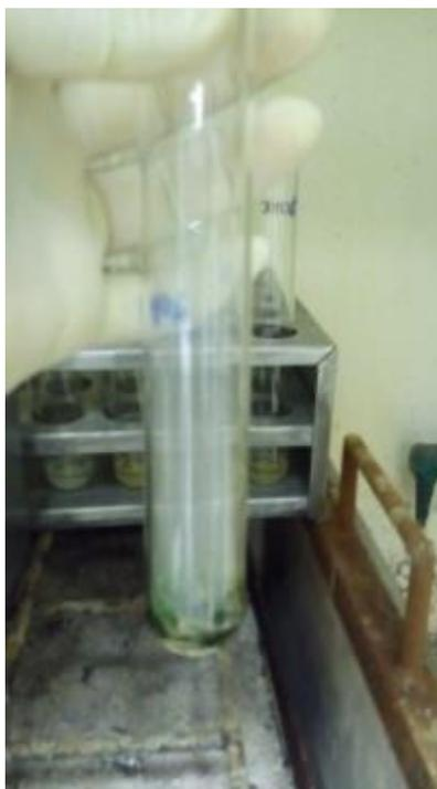
Figura 24. Adición de 2 ml de mezcla de ácidos a la muestra, bajo una campana de absorción de humos Marca TERMO SCIENTIFIC HAMILTON Modelo SAFEAIRE II.
