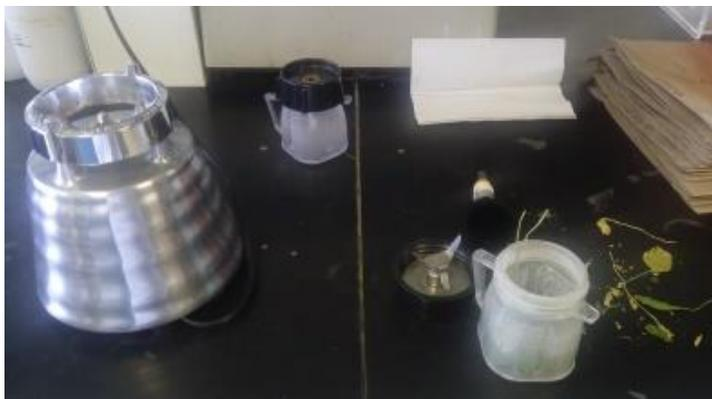
Figura 23. Molienda de muestras de materia seca en una licuadora Marca OSTERIZER Blender Modelo 004093-008-NP0, con aspas de acero inoxidable para evitar la contaminación de la muestra.
