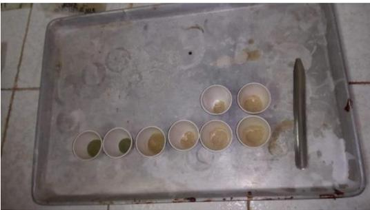
Figura 10. Muestras antes de ser calcinadas en la mufla.
