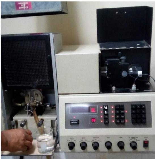
Figura 12. Espectrofotómetro de absorción atómica.
