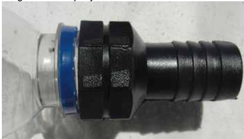
Figura 29. Acople y reductor instalados en la botella.
