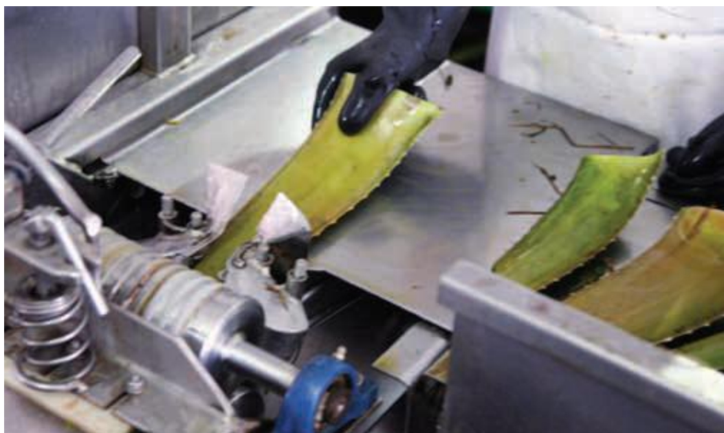
Figura 11. Fileteado mecánico. (método para la extracción de gel de sábila)
