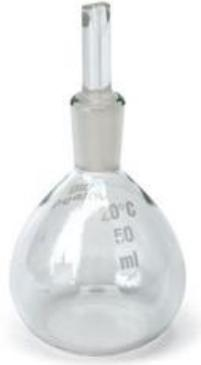
Figura 8. Picnómetro empleado para realizar las determinaciones de densidad.
