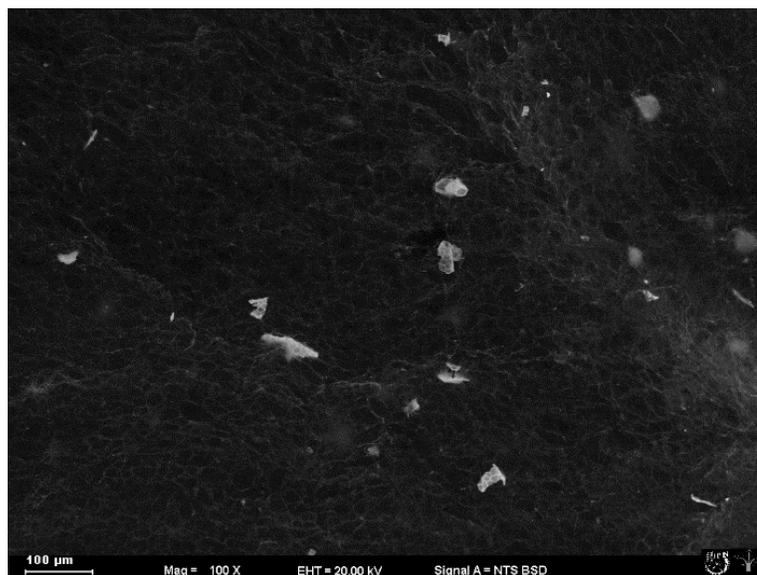
Figura 12. Análisis de Microscopia Electrónica de Barrido SEM. Imagen biopolímero solubilizado no filtrado de concentración (1 mg mL<sup>-1</sup>).
