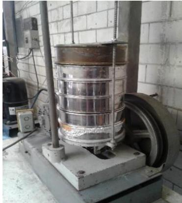
Figura 6. Sistema de tamizado empleado para separar el biopolímero de las semillas de chíá liofilizadas
