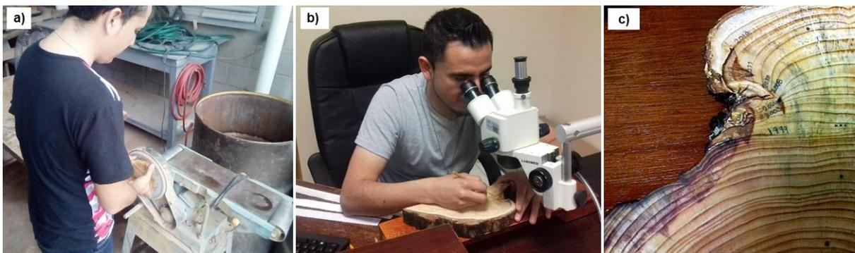
Figura 4. Lijado de muestras (a), pre-fechado (b) y ubicación de las cicatrices en la muestra (c).
