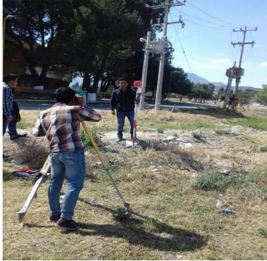
**Figura 7.1: Levantamiento topográfico con estación total**
