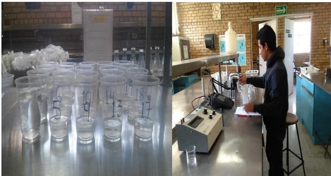
**Figura 7.4: Muestras del agua de riego recolectadas de la unidad experimental, llevadas al laboratorio de calidad de aguas, para analizar los parámetros de PH y Conductividad Eléctrica (CE) del mismo.**
