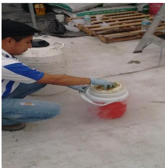
**Figura 5:** *Conservación de muestras en nitrógeno líquido.*
