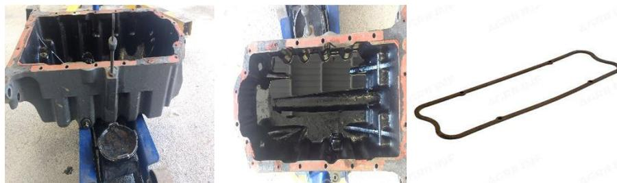
**Figura 22.** Carter. Lado derecho la junta del Carter
