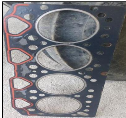
**Figura 15.** Junta de la culata
