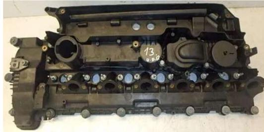
**Figura 16. Vista superior de la tapa de los balancines**
