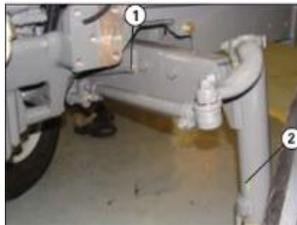
**Figura 27.** Articulación eje central delantero tracción sencilla
