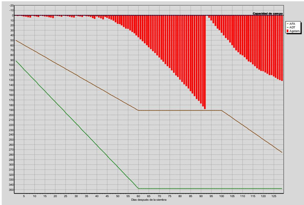
Figura 6. Abatimiento de la humedad fácilmente aprovechable para un cultivo de trigo en la región sureste de Coahuila.
