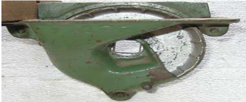
Figura 11 Vista lateral de un dosificador alimentado de fuerza interna.
