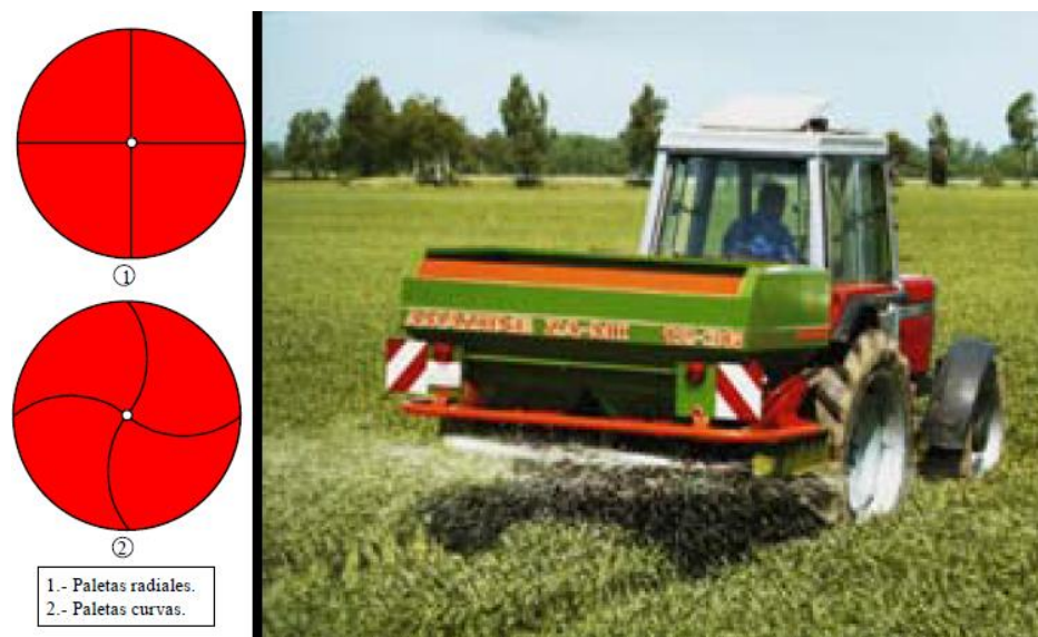
Figura 43 Nervaduras en discos y detalle de salida de fertilizante.
