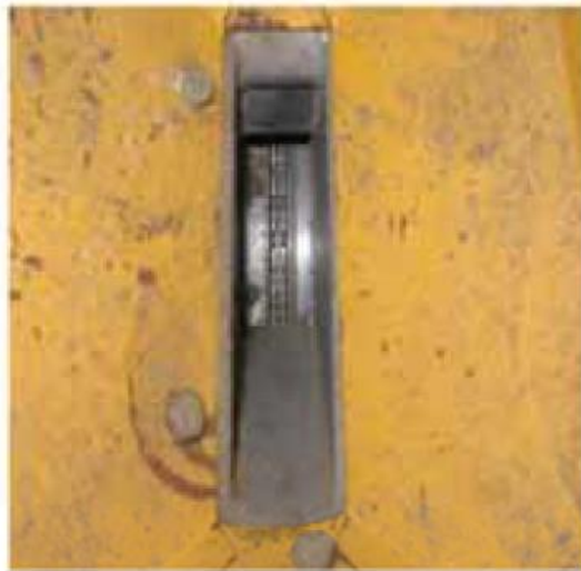
La porción expuesta del plato vertical a la base de la tolva
