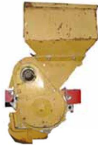
Dosificador de plato vertical incluyendo el abridor
