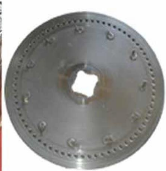
Disco dosificador de vacío
