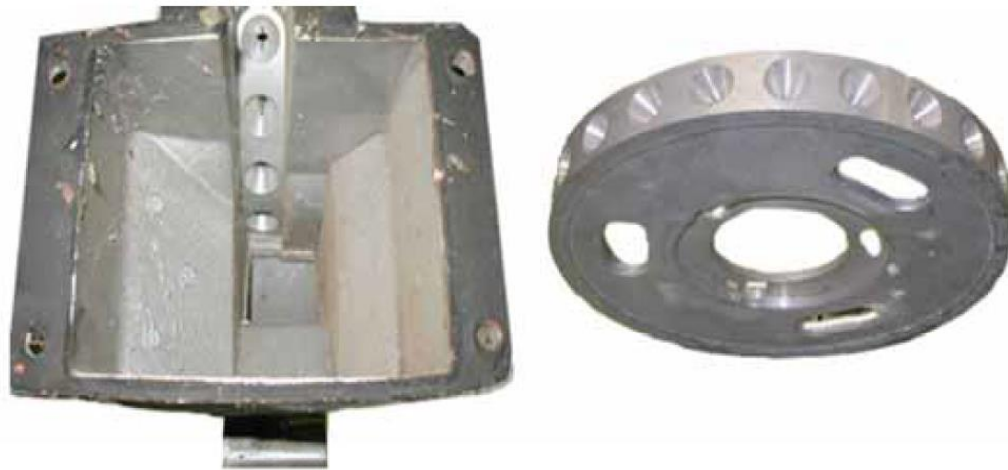
Base de la tolva de semillas (vena de aire removedora)
