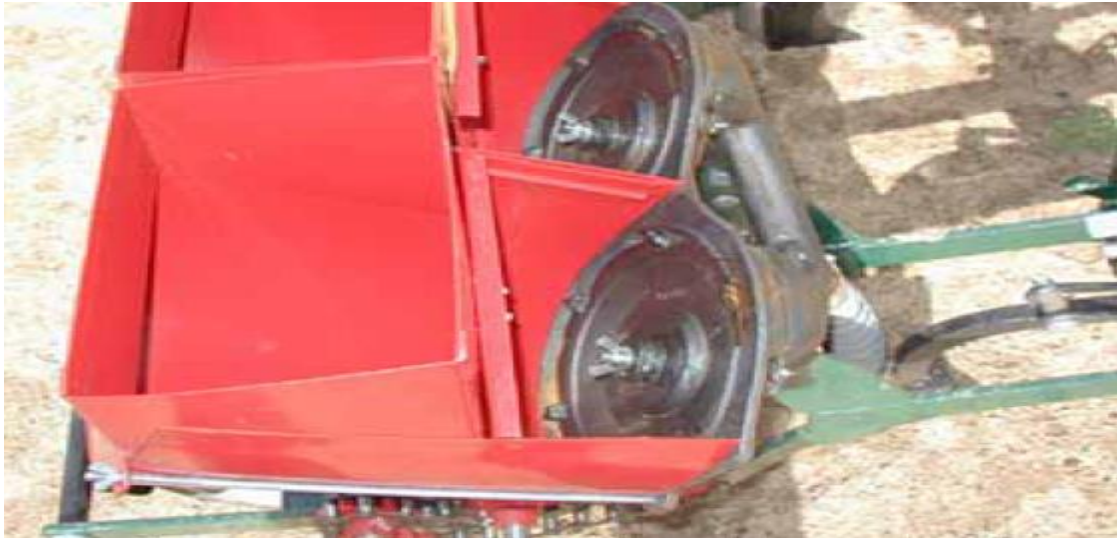
Figura 18 Dobles dosificadores de plato inclinado entregan semilla a un tubo de suministro común.
