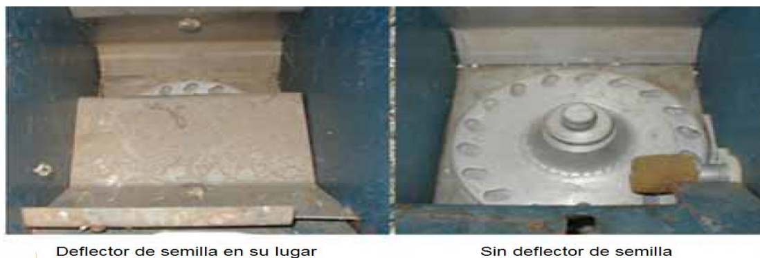
Figura 16 Vistas de un plato inclinado con y sin deflector de semillas en su lugar.
