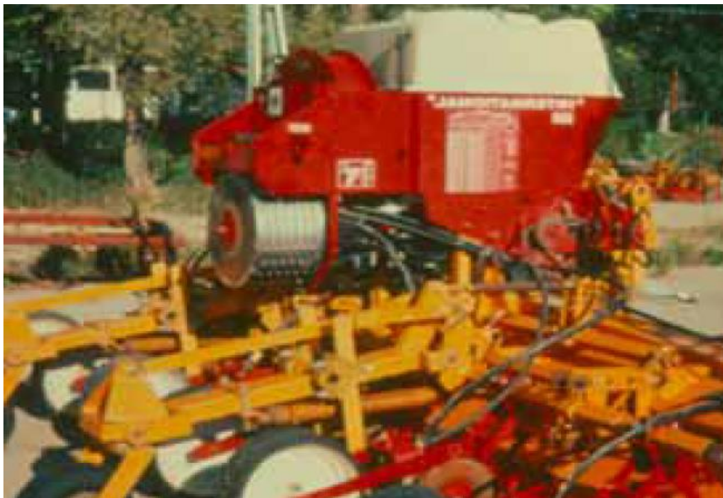
Figura 33 Vista lateral posterior de una unidad de dosificación de semillas de tipo tambor presurizado.
