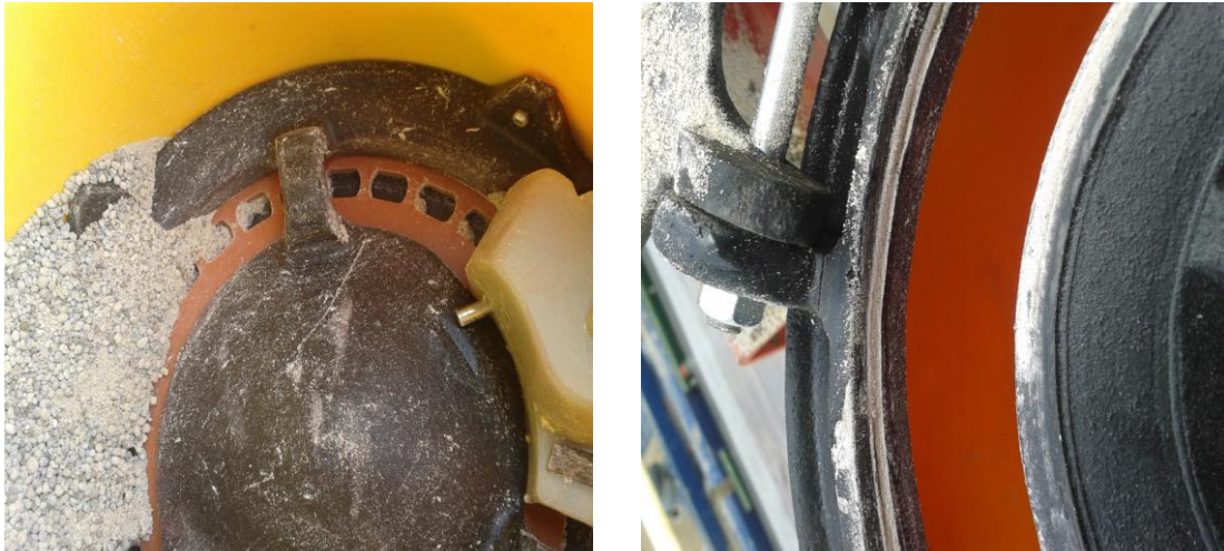
Figura 65 Atascamiento de plato horizontal por el fertilizante.
