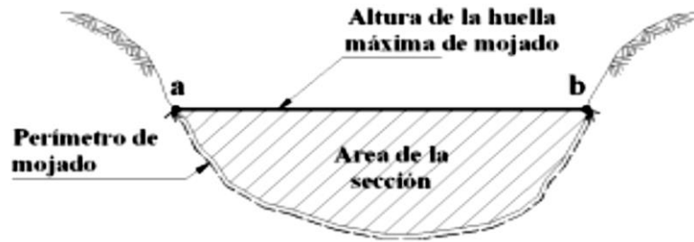
Figura 8. Elementos de una sección transversal.
