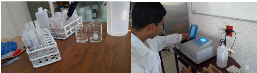
Figura 3.16 Determinación de flavonoides a) adición de agua destilada b) lectura de absorbancia.
