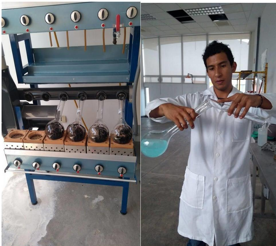
Figura 3.11. Determinación de proteína a) Etapa de digestión y b) Adición de hidróxido de sodio.
