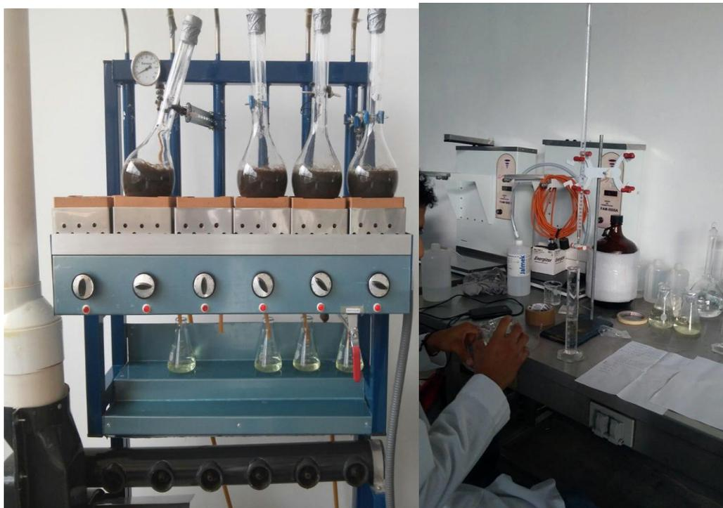
Figura 3.12. Determinación de proteína a) Destilación y b) Titulación.
