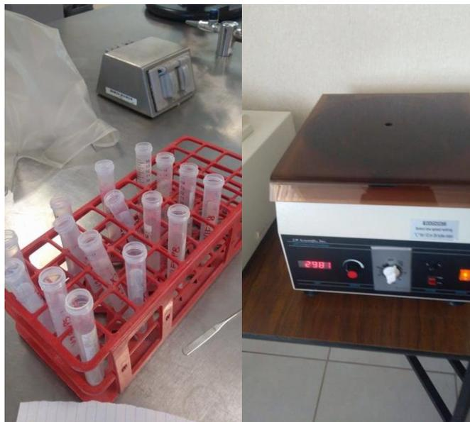
Figura 3.15. Obtención de extractos a) muestra con etanol y b) centrifuga.
