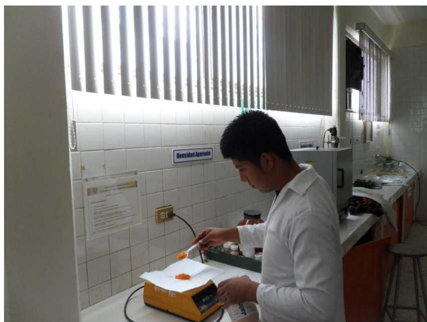
Figura IX.14.- Preparación de la solución de Dicromato de potasio \text{K}_2\text{Cr}_2\text{O}_7 .
