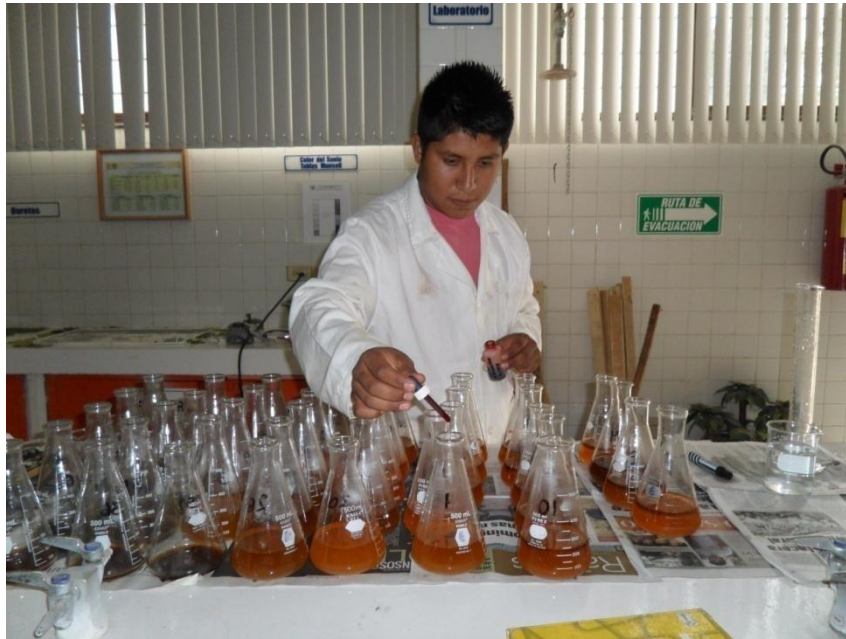
Figura IX.17 Adición de colorante Ortófenatrolina después de depositar el suelo pesado en un matraz, de agregar 10 ml solución de Dicromato de Potasio, 20 ml de ácido sulfúrico y 200 ml de agua destilada.
