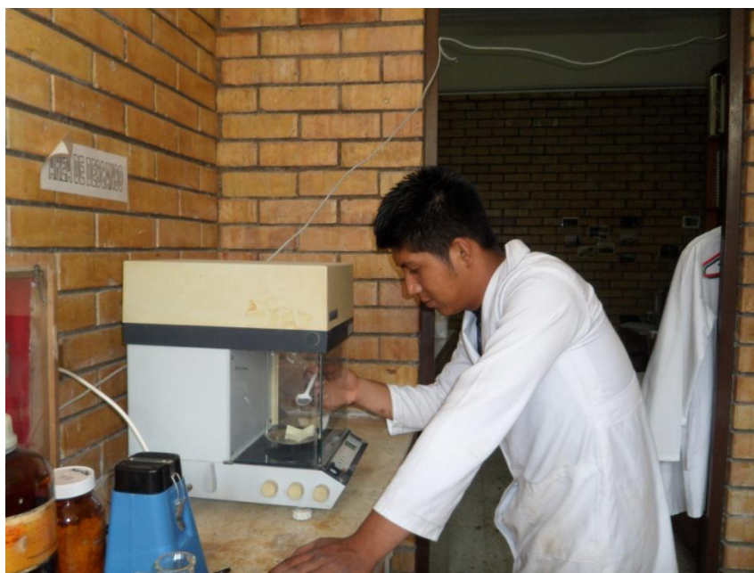
Figura IX.16 Pesado de 0.3 gr de la muestra de suelo para iniciar la determinación del % de materia orgánica.
