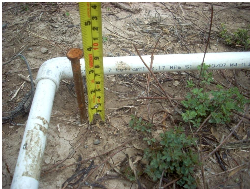
Figura IX.4.- Medición de la erosión con ayuda de un flexómetro en parcelas ya establecidas.
