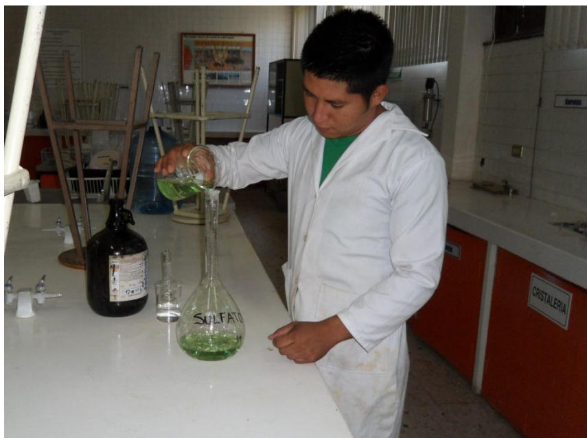
Figura IX.13.- Preparación de la solución de Sulfato Ferroso \text{Fe}_2\text{SO}_4 , para la determinación de materia orgánica.
