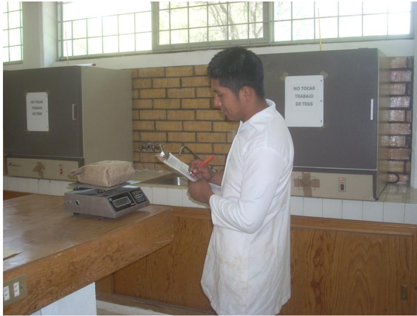
Figura IX.11.- Determinación de mantillo orgánico, las muestras se pesan y registran en un formato elaborado.
