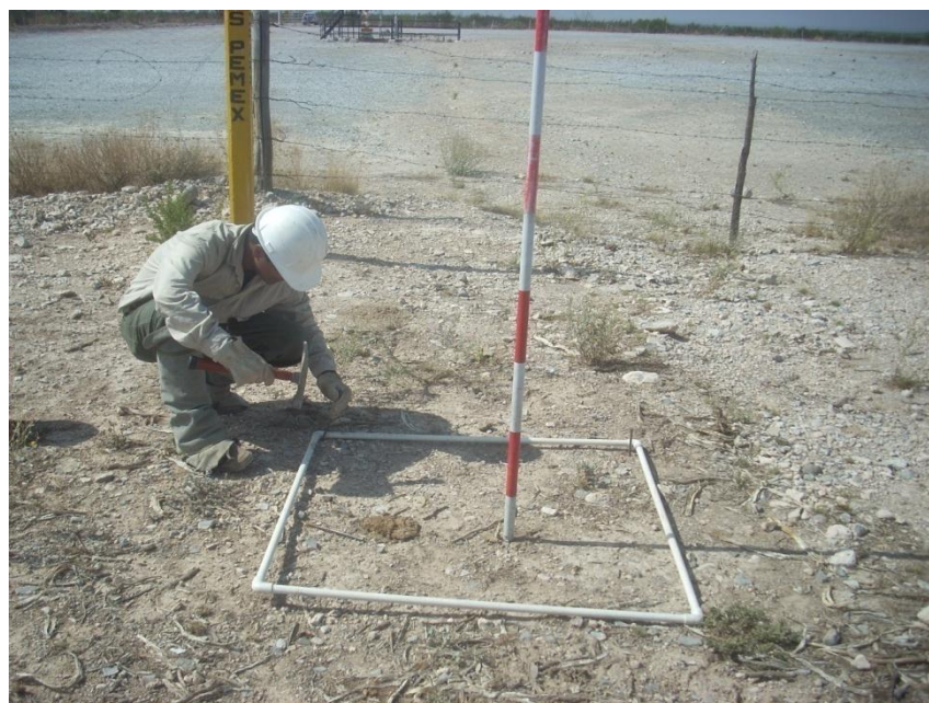
Figura IX.2.- Establecimiento de una nueva parcelade monitoreo para la determinación de erosión.
