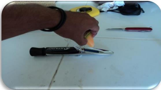
Figura 11. Colocación de la gota del jugo del melón
