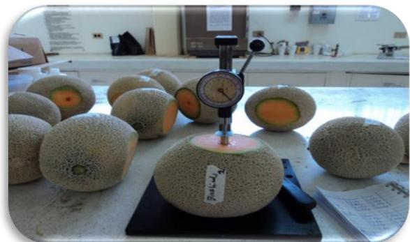
Figura 14. Medición de la firmeza del melón
