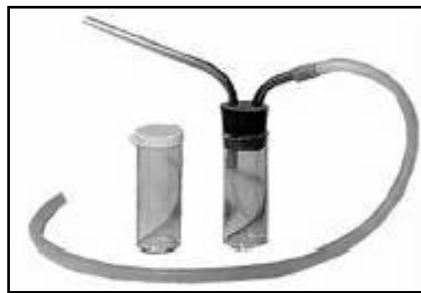
Figura 13. Succionador para la colecta de Diaphorina citri .
