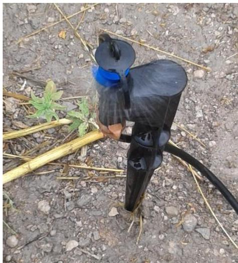
**Figura 3.7.** Microaspersor en funcionamiento con deflector.
