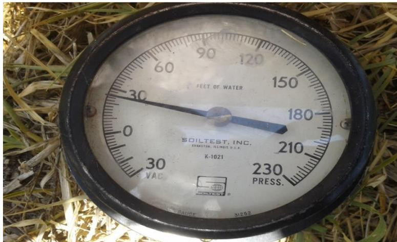
**Figura 3.6.** Lectura del manómetro al final de la línea.
